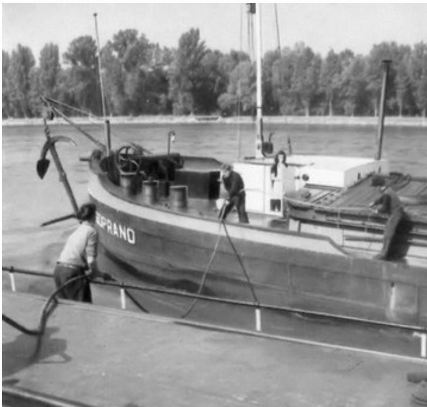
**Der Schleppdraht wird zum Schlepsschiff gezogen**
